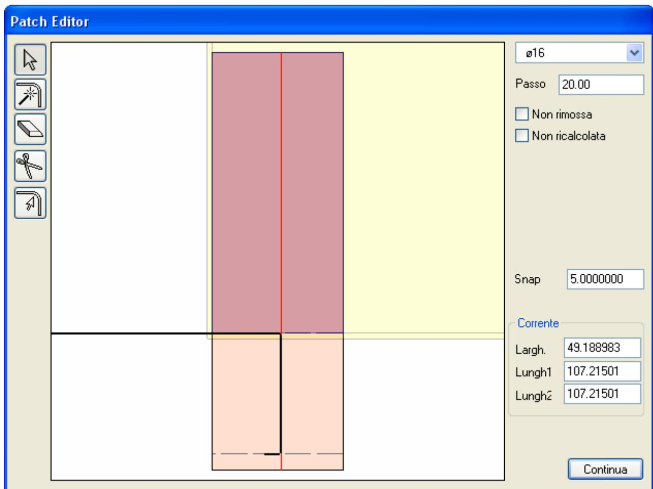
Si noti anche, nelle figure, che le misure della zona selezionata sono riportate sulla destra e sono editabili. Vi sono due misure di lunghezza perché, come detto, la forma del patch può essere trapezoidale.
