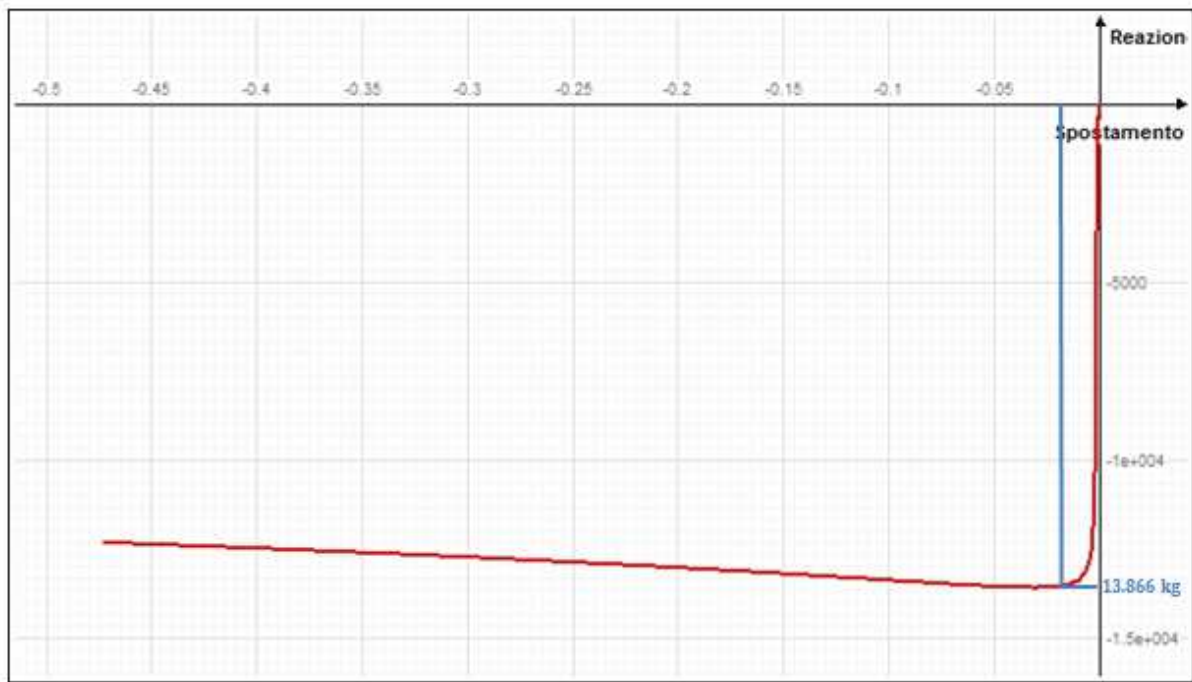
Fig.20 : Percorso di equilibrio post-critico in Nolian EE , il carico di collasso non può superare il valore Euleriano che rappresenta il carico di collasso per piccoli spostamenti, già per moderati spostamenti il valore si riduce
